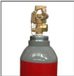
Il cilindro, conforme alle norme di sicurezza CE/TPED, contiene gas CO<sup>2</sup> ( in alternativa Argon, FM 200 estinguenti chimici ad esempio nel caso di metalli alcalini come il titanio) ed è dotato di una valvola che si attiva automaticamente tramite un attuttore pirotecnico o manualmente per mezzo di un comando di attivazione manuale.
