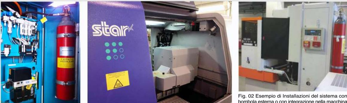
Fig. 02 Esempio di Installazioni del sistema con bombola esterna o con integrazioni nella macchina
